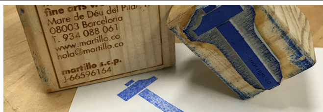
Ej. Corte láser sobre caucho para conseguir un sello
